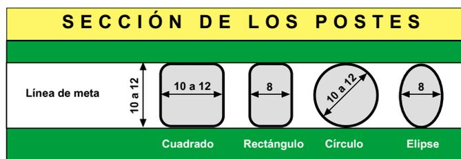
2. **Sujeción:** Los postes irán sujetos con firmeza al larguero. La fijación al suelo deberá ser preferentemente mediante tubo de anclaje con tapa, de la profundidad de empotramiento que proporcione la rigidez del poste adecuada. Todos los elementos
